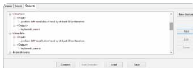
Obr. 3 Skript na zapnutie/vypnutie klimatizácie v prostredí FAAST
